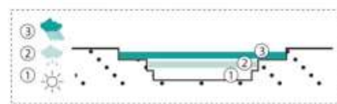
Wasserplatz als Retentionsraum bei Starkregen
